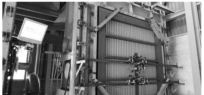
▲施行令39条・82条の4項に基づき、耐風圧性能を確認
